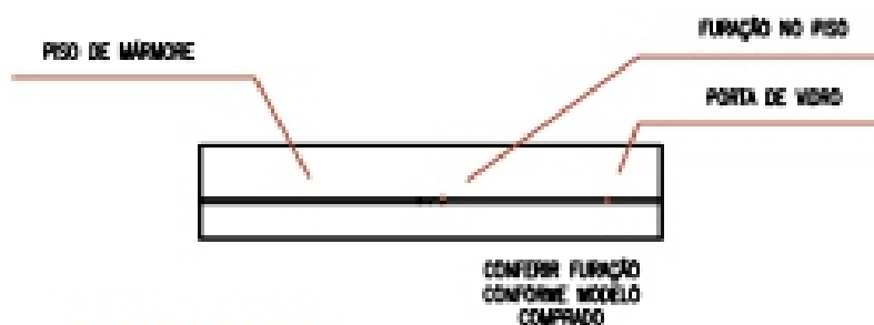
PLANTA BAIXA DETALHE FURAÇÃO PISO
