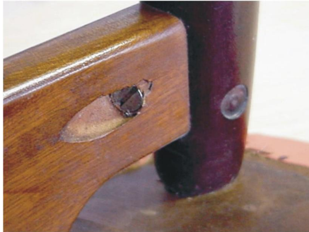
Fig. 14 – Furacão de boca de lobo (cadeira 1001)
