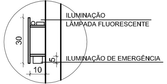
DETALHE CAIXA PASSAGEM ENERGIA 2o. PAVTO.
