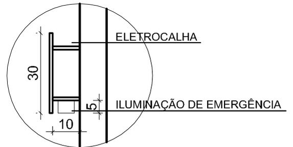
DETALHE CAIXA PASSAGEM ENERGIA 1o. PAVTO.
